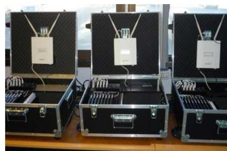
La valise Moduclass a été conçue pour transporter, protéger, sécuriser et recharger jusqu'à 20 tablettes 8, 10 ou 11 pouces si l'épaisseur des tablettes avec leurs housses de protection n'excède pas 13 mm.
