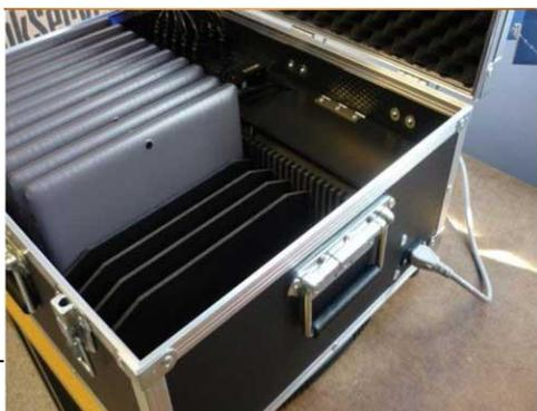
Les câbles USB sur micro USB ou Lightning (APPLE) pour le rechargement sont livrés et intégrés dans la valise, ce qui permet de récupérer les chargeurs livrés avec les tablettes pour une utilisation à domicile par exemple. VALISE TROLLEY MODUCLASS 12 ET 20 Marque et modèle déposés copyright Point SYS
