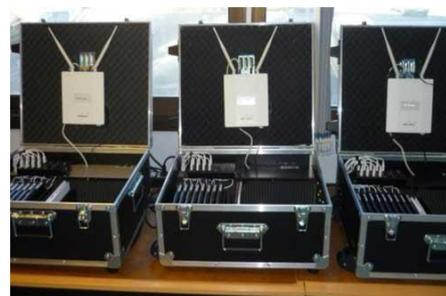
La valise Modulclass a été conçue pour transporter, protéger, sécuriser et recharger jusqu'à 20 tablettes 8, 10 ou 11 pouces si l'épaisseur des tablettes avec leurs housses de protection n'excède pas 13 mm.
